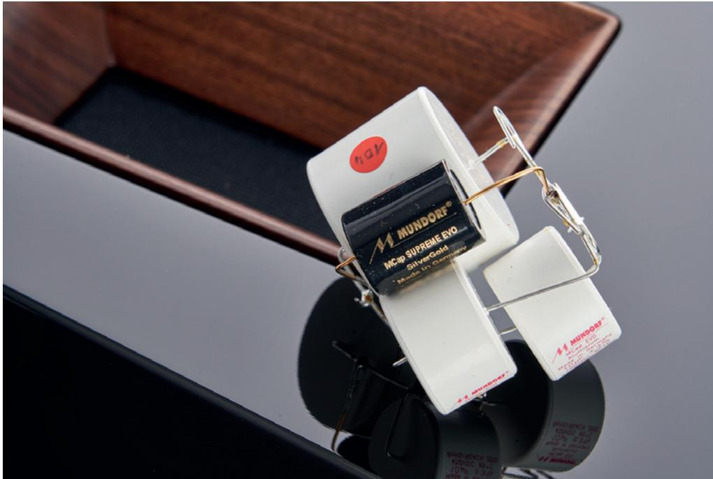
*Diese vier Kondensatoren bilden das Hochpassfilter vor dem Air Motion Transformer*
